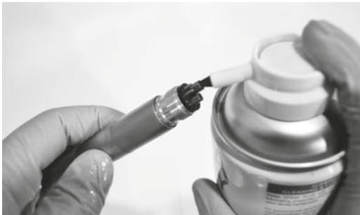
Einspritzen von Pflegeöl in den Spraykanal (Pflegeöl Art. Nr. 174010 und Spraykanaladapter Art. Nr. 17401150)
