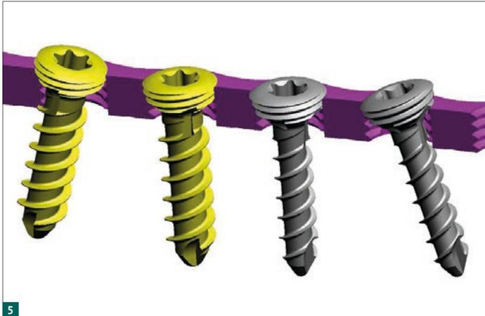
Abb. 5: Die 1,7 mm und 2,3 mm Verriegelungsschrauben können wahlweise in den Platten 2,0 mm x 5,0 mm und 2,4 mm x 6,5 mm miteinander kombiniert werden.
